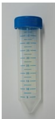
Figur 1 (en provtagningsburk med en blå kork, konbotten och mätningsskala på sidan)
