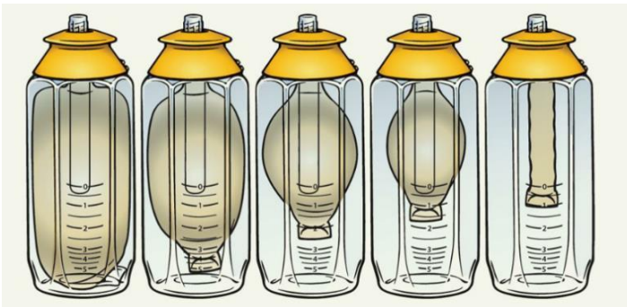
Kuvassa vasemmalla täysi pumppu, oikealla tyhjentynyt
